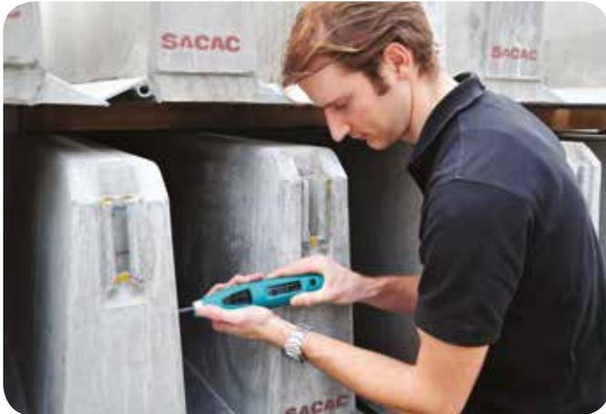
**ST/PC type N/L:** le scléromètre à rebond le plus sophistiqué du marché, avec des caractéristiques de dispersion, de durabilité, et une plage de mesure inégalées.
