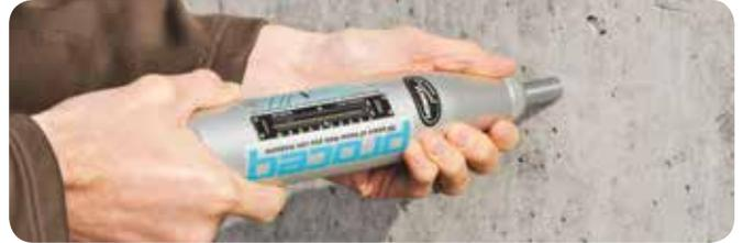
**Type N/L:** la référence pour tous les scléromètres à rebond et la base pour la définition de chaque norme internationale sur les scléromètres à rebond. Disponible avec différentes énergies d'impact pour permettre aux clients de tester un large choix de matériaux et de types de structures.
